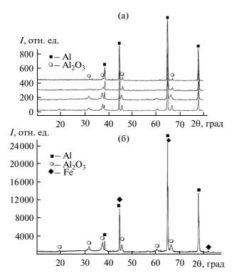
**Рис. 3.** Результаты рентгенофазового анализа образцов с покрытиями, сформированными при разных концентрациях Fe(III). На рис. (а) нарастание концентрации железа снизу вверх. Съемка с накоплением сигнала (б) выполнена при концентрации Fe(III) 0.03 моль/л.
