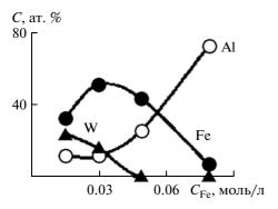
**Рис. 9.** Влияние концентрации железа(III) в электролите на элементный состав кристаллитов в поре по данным дисперсионного анализа. Содержание кислорода меняется в пределах 10—30 ат. %, углерода не более 5 ат. %, фосфора не более долей ат. %.
