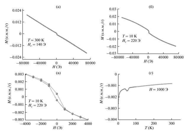
Рис. 7. "Обратная" намагниченность образца.
