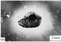
**Рис. 8.** ЭСМ-изображения кристаллитов (а—в) в порах покрытий, сформированных в электролитах с концентрацией  $Fe^{3+}$  0.049 (a, б) и 0.03 моль/л (в).
