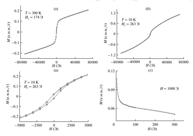
**Рис. 5.** Кривые намагниченности образца, сформированного в электролите с концентрацией Fe(III) 0.03 моль/л при 300 К и 10 К.
