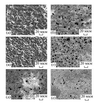
**Рис. 2.** ЭСМ-изображения поверхности Fe-содержащих ПЭО-покрытий, полученные в режиме рельефного (а, в) и фазового (б,  $\Gamma$ -е) контрастов. Покрытия сформированы в электролитах, содержащих различные концентрации Fe(III), моль/л: 0.015 (а, б), 0.03 (в,  $\Gamma$ ), 0.049 (д) и 0.079 (е).
