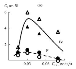
**Рис. 4.** Влияние концентрации Fe(III) в электролите на усредненный по площади элементный состав сформированных покрытий. Незакрашенные точки — определение с площадок  $300 \times 200$  мкм (микрозонд), закрашенные — усреднение по данным с площадок  $\sim 10 \times 10$  мкм, полученных на электронном микроскопе (энергодисперсионная приставка).
