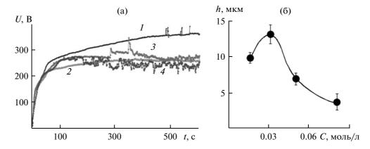
**Рис. 1.** (а) Временные зависимости изменения напряжения на электродах при содержании в PBWFe-электролите железа(III), моль/л: I - 0.015; 2 - 0.03; 3 - 0.049; 4 - 0.079. (б) Влияние концентрации Fe(III) в PBWFe электролите на толщину сформированных на сплаве алюминия покрытий.
